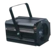
Proiettore con corpo in metallo e profili in alluminio con lente fresnel; per lampada alogena da 650W o 1000W con base GX9,5; completo di forcella, telaio porta gelatina, rete di protezione, cavo di alimentazione e maniglia atermica.
