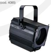
Proiettore da 2000W di elevata qualità ottica e meccanica. Lente fresnel, corpo in alluminio pressofuso ed estruso. L'angolo del fascio di luce è regolabile tra le posizioni spot e flood con la pratica doppia regolazione a pomoli esterni posizionati sia nella parte frontale che posteriore. Fornito con telaio portagelatina, rete di protezione, forcella ad avanzamento regolabile e cavo di alimentazione.
