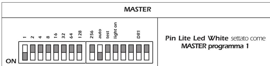
Per configurare **Pin Lite Led White** come **MASTER** è sufficiente portare il dip-switch **Auto** su **ON** e scegliere un programma da eseguire selezionando uno dei seguenti dip-switch: **1-2-4-8-256**.
