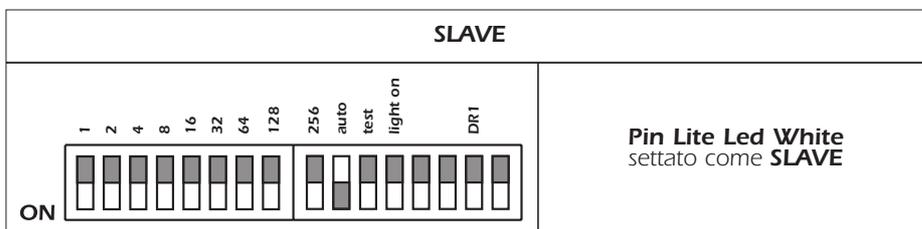
Per configurare **Pin Lite Led White** come **SLAVE** è sufficiente portare il dip-switch **Auto** su **ON**. **Tutti** gli altri dip-switch devono essere in **OFF**.
