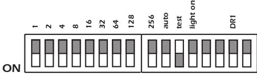
posizionando il dip-switch su **ON Pin Lite Led White** esegue un test rapido di tutti i canali in sequenza
