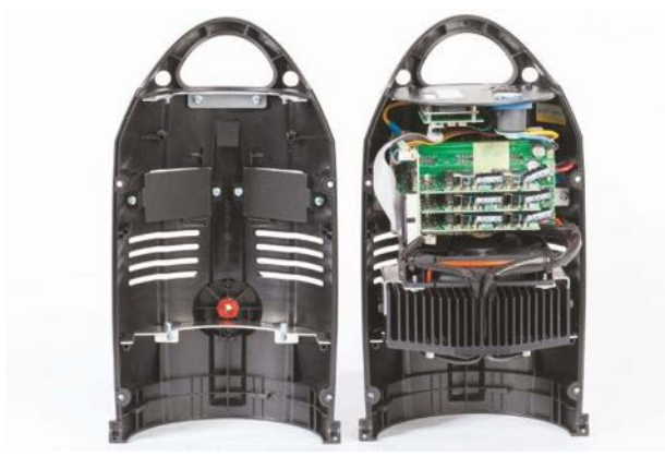
Öffnet man eine Halbschale sind alle internen Komponenten einfach und direkt zu erreichen
