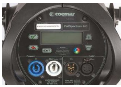
Anschlussterminal hervorragend gelöst die 6-Tastenbedienung mit einer Taste für direkten Zugriff auf Stand-Alone-Bedienung
