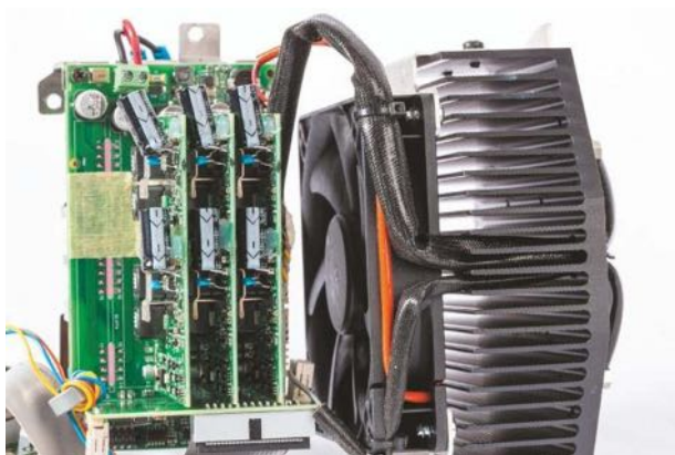
Klassische Zwangskühlung auf die Kühlrippen, die Elkos hatten sich bei unserem Testgerät bereits von der Verklebung gelöst
