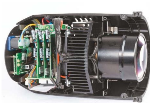
Auf einer Schalenseite sind Elektronik, Kühlung, LED und die Optik befestigt, wodurch ein schneller und einfacher Zugriff erfolgen kann
