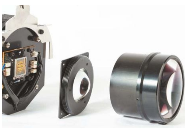
Doppelkondensor vor der Lichtquelle, mit sehr stark gewölbter primärer Kondensor-Linse
